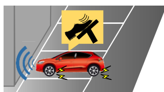
②車線逸脱支援装置 (レーンキープアシスト:LKAS)
